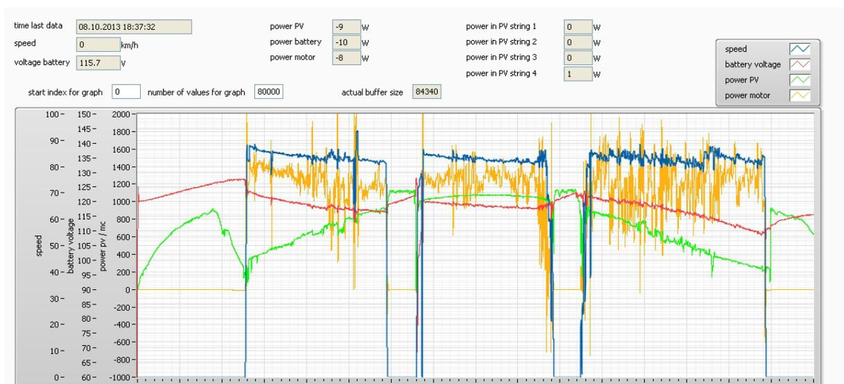
**Bild 4** : Im Begleitfahrzeug sind alle wichtigen Betriebsdaten auf einen Blick auf dem Monitor erkennbar: die Photovoltaik-Leistung (grün), die Batteriespannung (rot), die Motorleistung (orange) und die resultierende Fahrzeug-Geschwindigkeit (blau)
