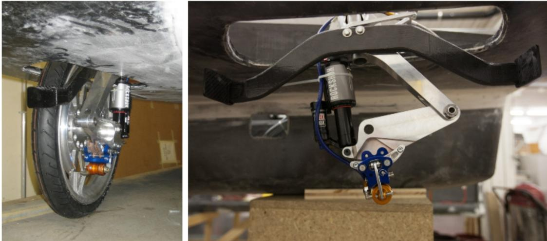
**Bild 2** : Die vier Räder der neuen Fahrwerksgeneration sind dank ausgetüftelter Konstruktion kleiner, komfortabler, wirksamer und vor allem leichter als die drei Räder des Vorgängermodells
